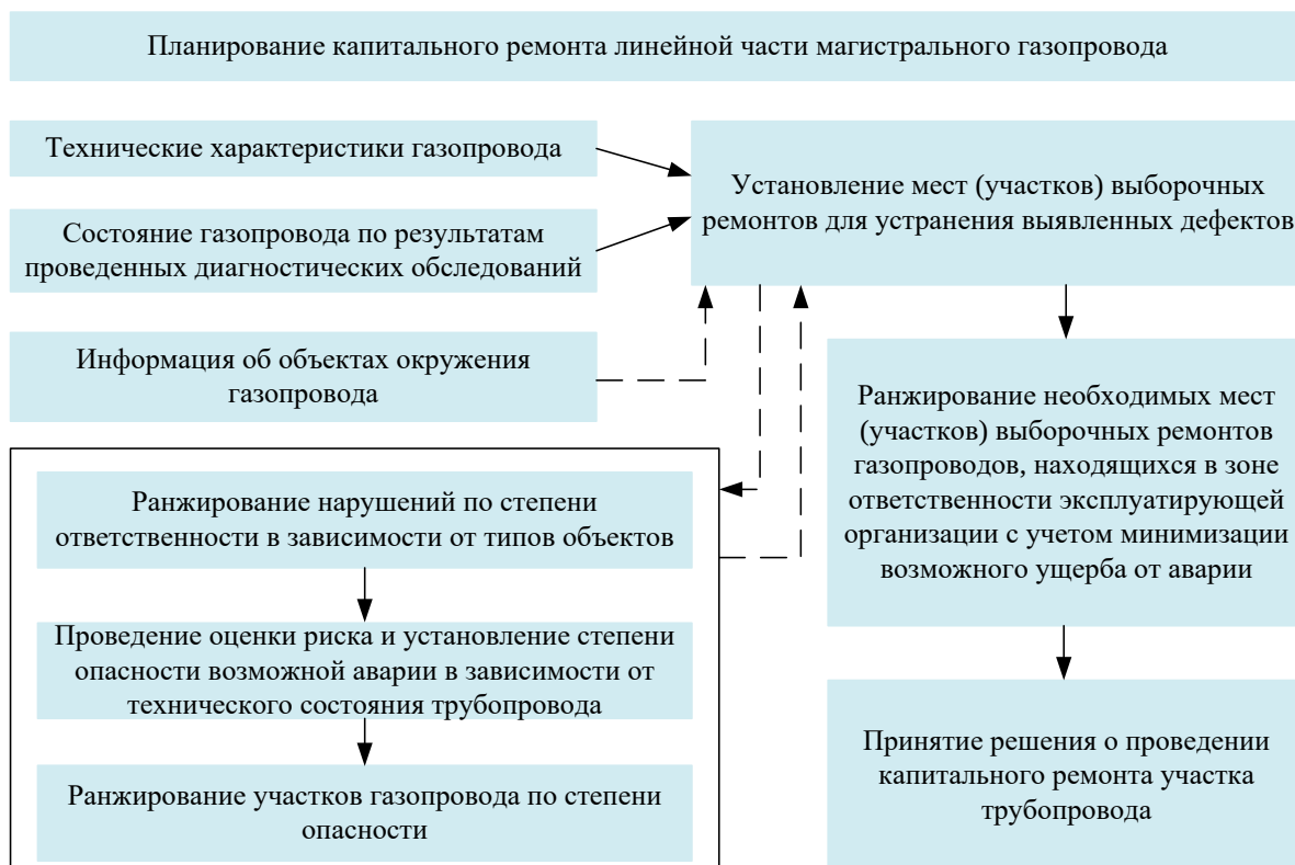
Рис. 1. Схема планирования капитального ремонта с учетом минимизации последствий аварий (12 шрифт, курсив)
